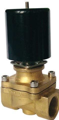
Электромагнитный клапан предназначен для работы в качестве запорного двухпозиционного устройства дистанционного управления потоком среды в трубопроводах. Управление клапаном производится путем подачи напряжения на катушку.
