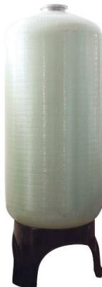
Корпуса скрытых фильтров Canature выполнены из композитного материала, на который намотана стекловолоконная нить по бесшовной технологии. Все резьбовые отверстия в корпусах сделаны из стеклонаполненного полипропилена для обеспечения высокой прочности; резьбовая вставка снабжена механическим замком. Толщина стенки корпуса варьируется в пределах от 3,0 до 8,0 мм в зависимости от его диаметра. Все части корпусов, контактирующие с водой, выполнены из коррозионностойких материалов пищевого качества.
