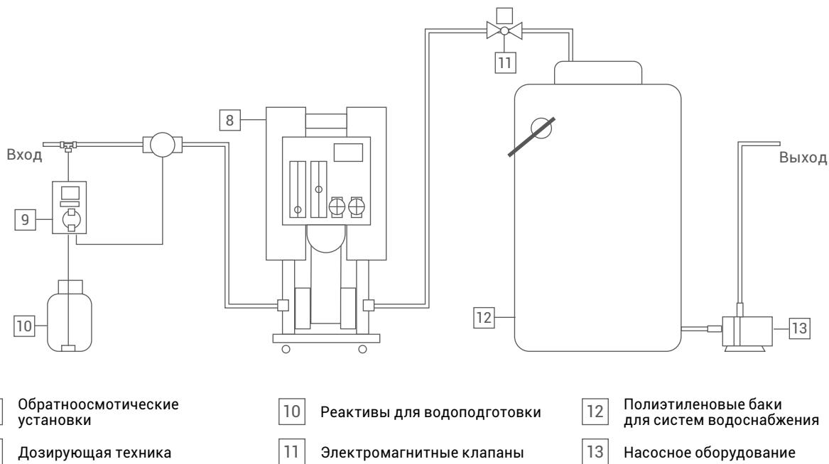
Установки, в состав которых входят обратноосмотические мембранные элементы, предназначены для получения, в первую очередь, обессоленной воды. В основе процесса обратного осмоса – пропускание воды под давлением через полупроницаемую мембрану. При этом происходит разделение исходной воды на два потока: пермеат (обессоленная вода) и концентрат (концентрированный раствор примесей).
