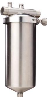
Корпус фильтра состоит из основания и крышки, соединенных между собой хомутом. Фильтрующий мешок вставляется в каркас жесткости. Сверху она закрывается крышкой каркаса и зажимается держателем. В комплект фильтра входит кронштейн для размещения его на стене. Нижний слив позволяет безопасно слить остатки из корпуса и облегчить обслуживание фильтра.
