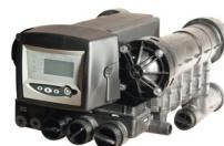
Блоки управления позволяют промывать загрузки скорых фильтров обратным потоком воды (снизу вверх), прямым потоком воды (сверху вниз), производить промывку реагентом путем всасывания его через встроенный эжектор, автоматически наполнять реагентный бак водой. Блоки состоят из клапанов, которые осуществляют включение, выключение и перенаправление потока воды, и контроллера, обеспечивающего работу клапанов, то есть задающего последовательность переключения потоков.
